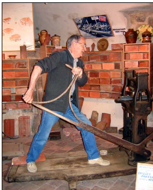
Presse rebatteuse en action (machine de 1890)
