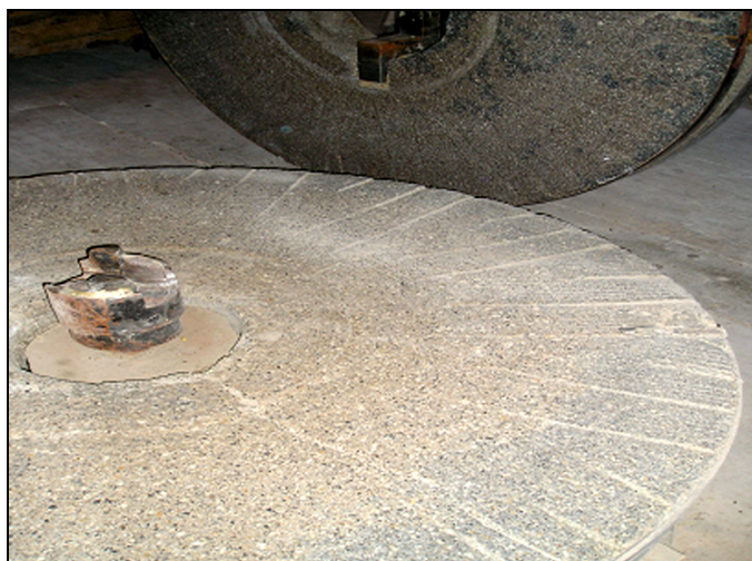
Meule "courante" avec œillard central et rainures pour évacuer la farine
