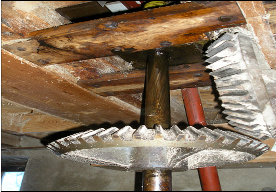
Autour de l'axe central (1) les deux roues dentées (2-3)
