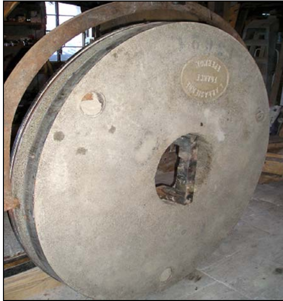
Meule mise à la verticale à l'aide de la potence
