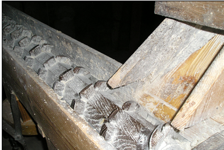
Tunnel et vis sans fin
