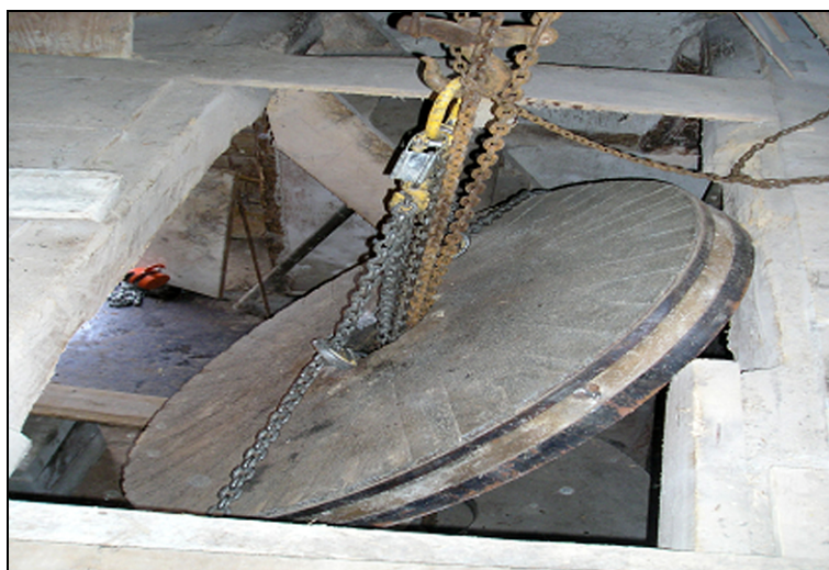
Descente de la meule par la trappe avec le palan
