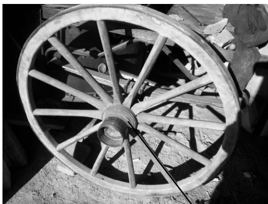
Roue équipée d'une frette extérieure striée pour servir de marchepied (P.-M. Therrat)
